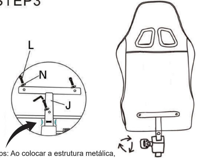
Tips: Ao colocar a estrutura metálica, manter a cavidade voltada para o lado exterior, conforme a imagem.
