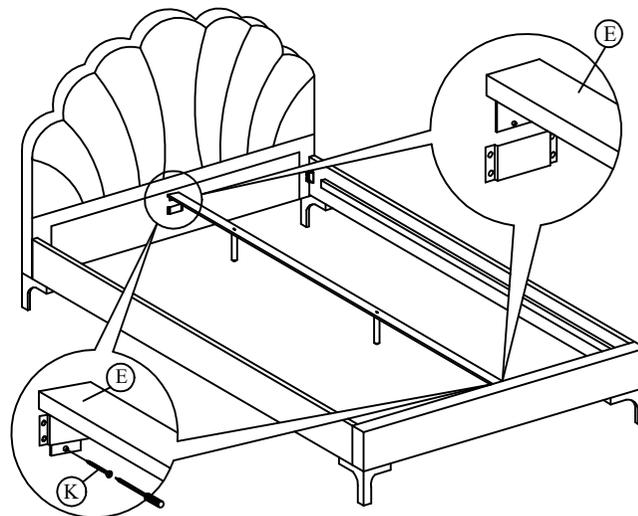
**Atenção :** Certifique-se de que o parafuso (L) é aparafusado de acordo com o manual mostrado para evitar colapso da base.
